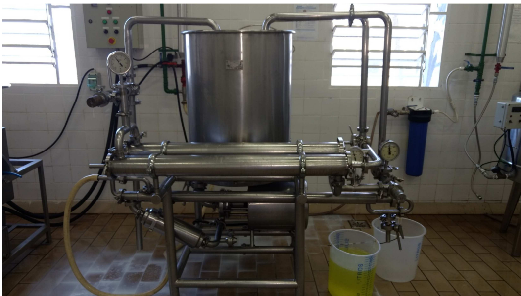
Figura 1 - Equipamento de concentração por ultrafiltração utilizado na EPAMIG Instituto de Laticínios Cândido Tostes.
